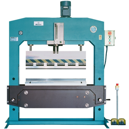
Prensa de 100 tm con opcional de equipo de plegado de 1200 mm
