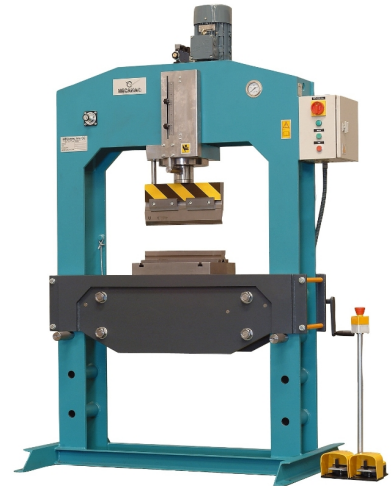
Prensa de 80 tm con opcional de equipo de plegado de 415 mm
